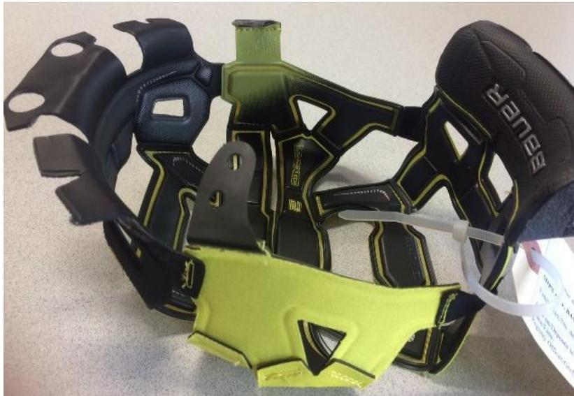
[212] Comme ces éléments de fixation se déforment et dissipent l'énergie lors de l'impact, MIPS affirme qu'ils contrefont également la revendication 4 du brevet MIPS 542.
