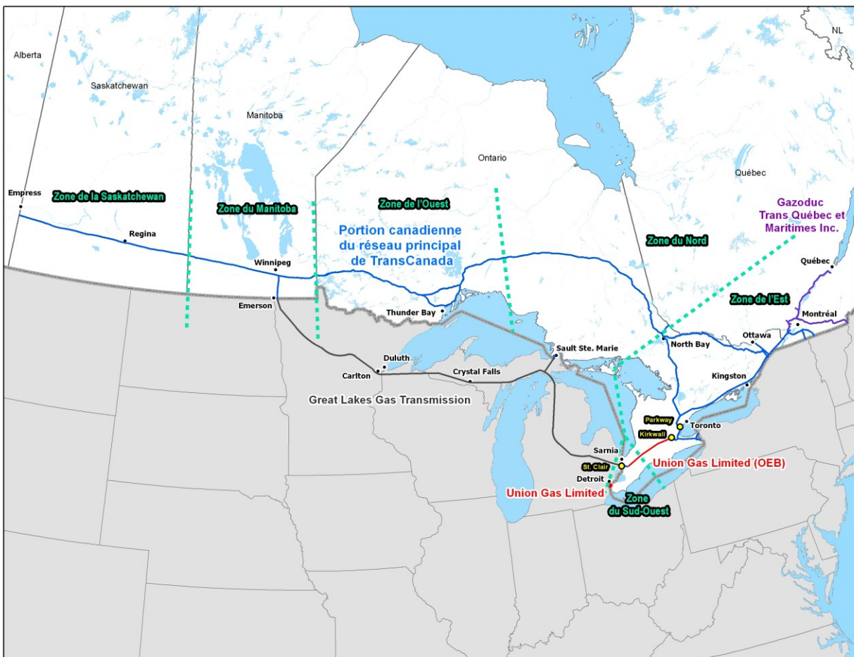
Figure 2-1 Réseau principal de TransCanada
